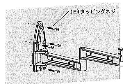
②取付ける位置が決まつたら、壁に壁側アーム金具を合わせ、市販の水平器などで水平を確認しながら4本のタッピングネジで壁に取付けてください。壁側アーム金具を壁面に取り付けた後は、必ず安全かどうかを確認してください。
