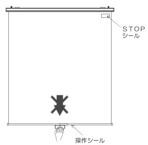
4 収納する時は、スクリーン下部の引下金具を持って ほんの少し下に引いて手を離して下さい。 スクリーンはゆっくり収納されます。
