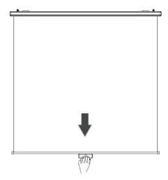
3 スクリーンの引き下げ限度を超して無理に 引き下げないで下さい。 (STOPシールが限界です) 限度を超して無理に引き下げると、スクリーンが 巻取パイプより剥がれて落下して事故の 原因になります。
