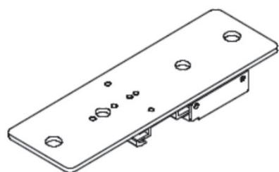
※ 左右のボルト吊金具は、なるべくケース両端の位置になるように、しっかりと固定して下さい。
