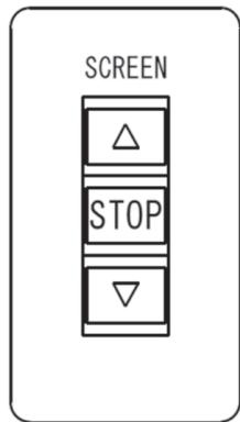
スイッチはパルス式ノンロックスイッチを使用しています。ボタンを一度押せば製品の内蔵リレーが作動して、あらかじめ設定した停止位置まで自動的に動き停止します。
