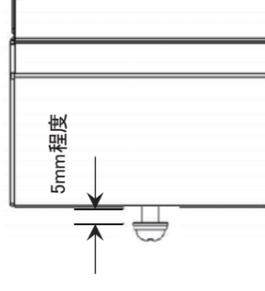
② モニター受金具の上側の孔に先に取付けたネジの頭部を差込み、支柱に金具を引掛けてください。その後、下側の孔を使って支柱とネジで固定してください。
