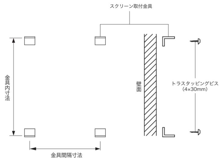
金具内寸法 = (スクリーンH寸法) + 2mm
