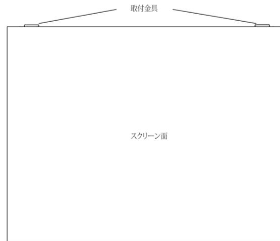
(2) スクリーン本体を取付金具の間に入れ込み、付属のトラストッピングビス(4×12mm)でしっかりと固定します。
