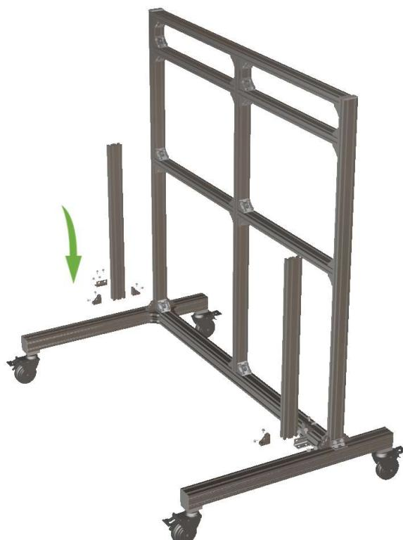
図のように2本のアルミフレーム柱をSコーナー金具
