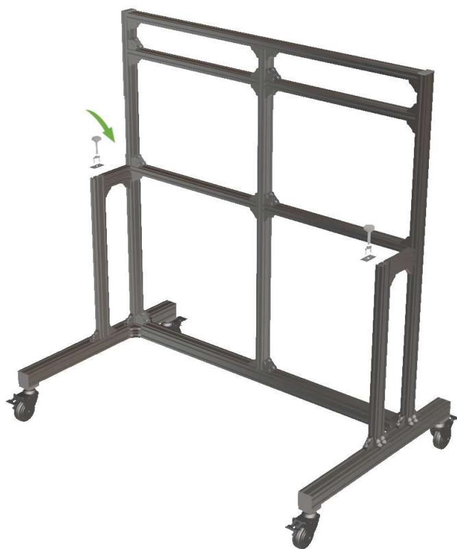
W30×D60のアジャスター金具をM6×15キャップボルト2本で2カ所固定しM10アジャスターを、ナットを付けて取り付けます。
