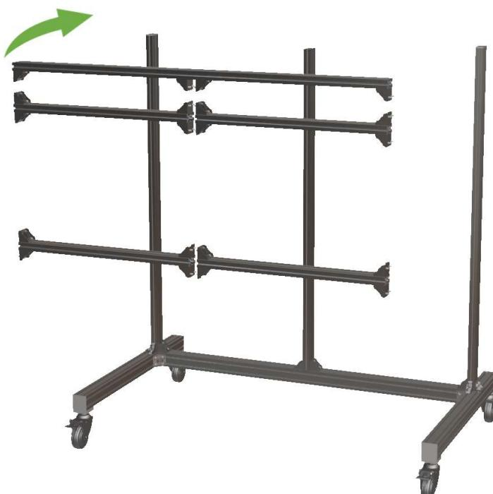
図のように6本のアルミフレームをWコーナー金具でM6×18ボルト×80本で20箇所固定します。
